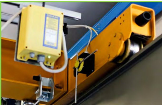
На фото использование FCR на мостовом кране
